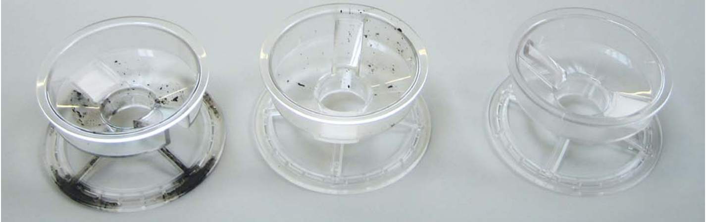
Gefahr bei Material- und Farbwechseln: Reste und Verbrennungsrückstände in der Folgeproduktion führen zu Qualitätsverlusten
