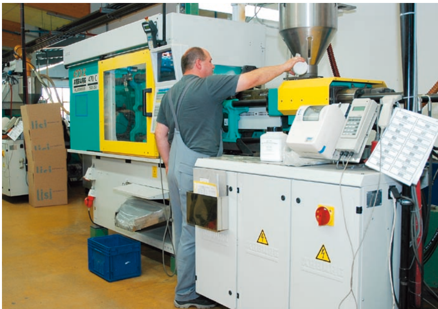
Einrichter Stefan Hohmann lässt die Spritzgießmaschine rund 1 Kilogramm Granulat mit 1 Prozent Reinigungskonzentrat einziehen und einige Minuten einwirken.
