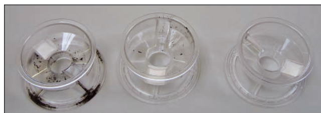
Einführen des zum Patent angemeldeten neuen Reinigers „Per-tas“ – nach drei Schuss sind die Spritzgussartikel sauber Fotos: Schulz
